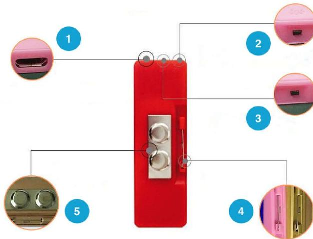
1. Micro USB Typ B Buchse, zur Ladung und Programmierung
